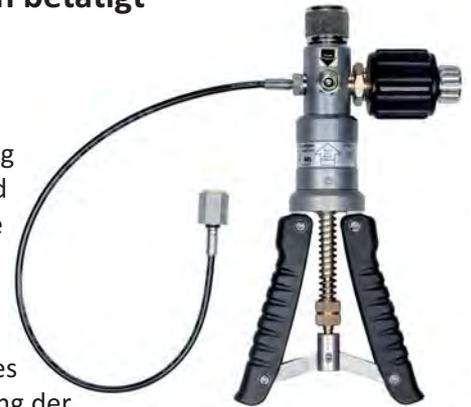
Schließt man das zu prüfende Messgerät und ein ausreichend genaues Referenz-Messgerät an der Handtestpumpe an, so wirkt bei Betätigung der Pumpe auf beide Messgeräte der gleiche Druck. Durch Vergleich der beiden Messwerte bei beliebigen Druckwerten kann eine Überprüfung der Genauigkeit bzw. eine Justage des zu prüfenden Druckmessgerätes erfolgen.
